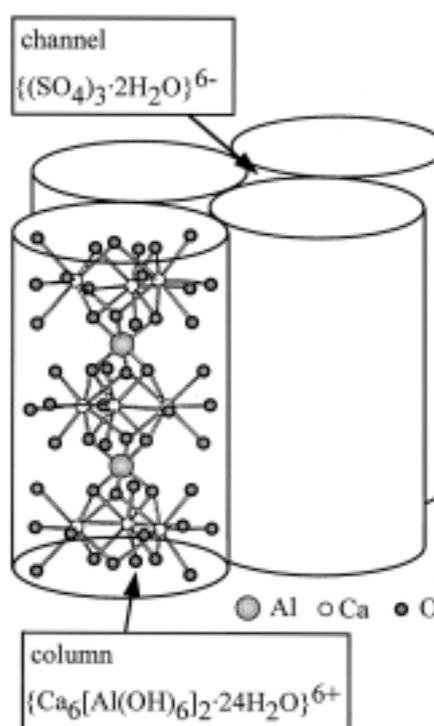
Fig.1 Structure of ettringite [3-4].
