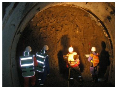
地下深くにある断層の直接 目視による調査
