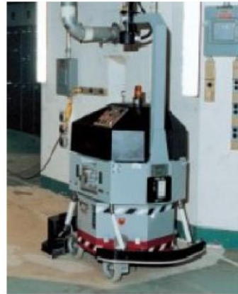
移動型汚染測定器(C P-5) 廃棄物の放射能評価システム
