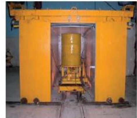
移動型汚染測定器(C P-5) 廃棄物の放射能評価システム
