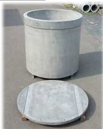
1m 3 PIC容器 積み重ね、貫通試験を実施し異常は認められなかった。
