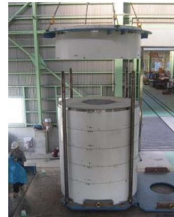
鋼殻リング法によるPEM組立実証 (RWMC, 2011)
