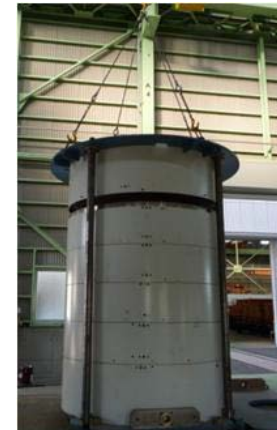
鋼殻リング法によるPEM組立実証 (RWMC, 2011)
