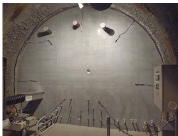
コンクリートプラグ・加熱試験
