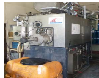
図3 横ドラム型減圧乾燥装置
