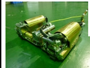
格納容器漏えい個所特定調査技術の開発
