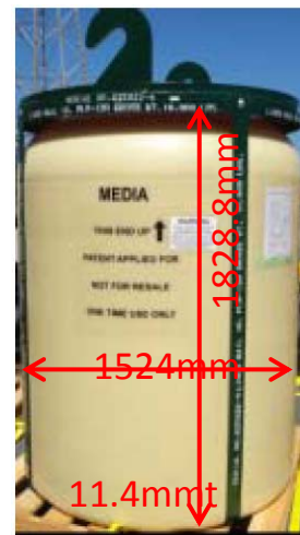
HICタイプ1(補強体無)の外観
