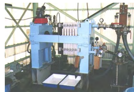
真空加圧脱水固化処理機(小型タイプ) (名称:スーパーバキュームプレス、略称:SVP)
