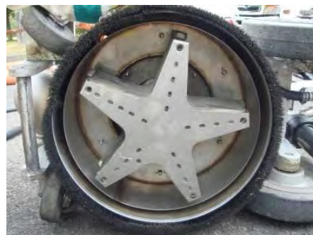
スターノズルセット 道路白線消去用 最大20穴
