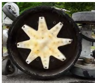
オクトパスノズルセット 除染用に開発 最大36穴
