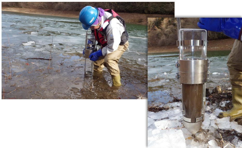
柱状堆積物試料の採取 (不攪乱柱状採泥器)
