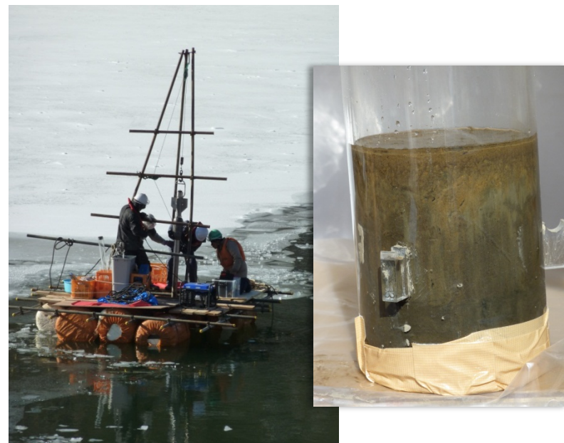
柱状堆積物試料の採取 (重锤型柱状採泥器)
