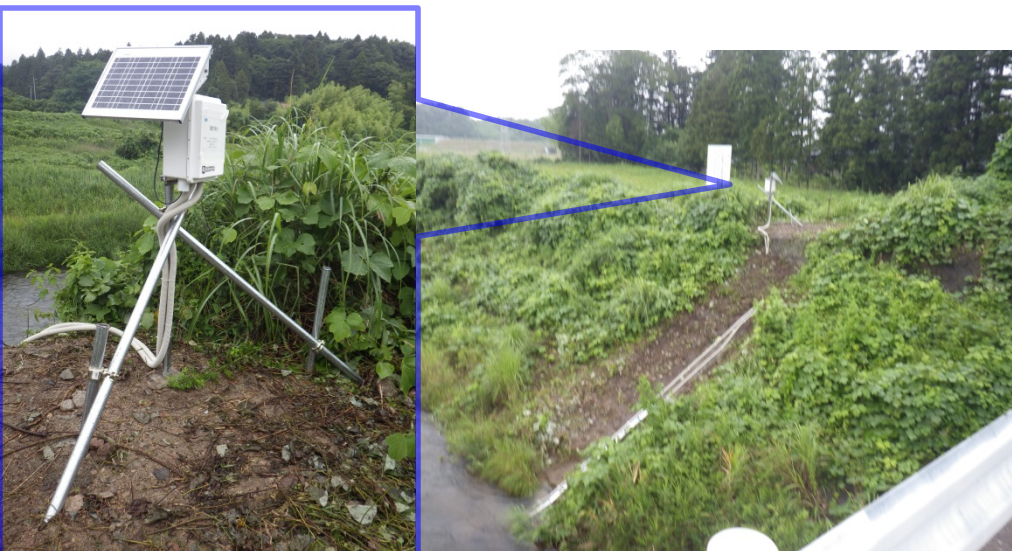
自動観測機器(水位、濁度)
