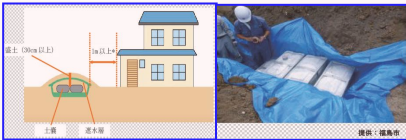
現場保管の例(地下保管)
